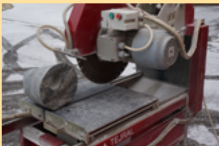
Řezání vzorku horniny z odvrtného jádra
