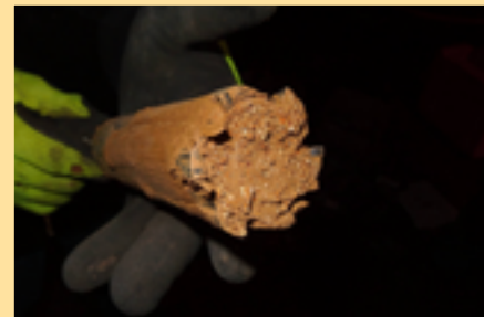
Odvrtaný vzorek bentonitu
