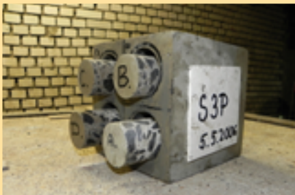
Vzorky betonu z ÚRAO Richard pro využití v CORI
