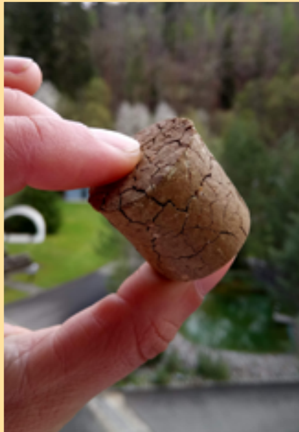
Vzorek z bentonitového těsnění hráze
