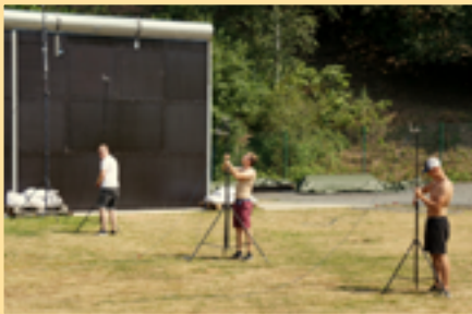
Akustické měření na protihlukové stěně
