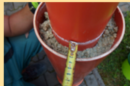
Umístění těsnícího prvku v mezikruží modelu HG vrtu
