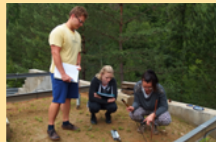
Práce s elektronickým hydrostatickým hladinoměrem
