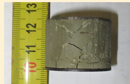
Vzorek bentonitu po tlakové zkoušce
