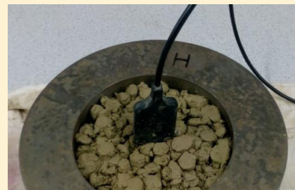
Instalované čidlo ve zhutněném bentonitu
