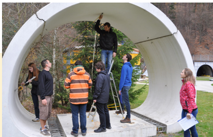
Princip měření konvergence
