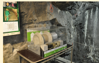
Model těsnící zátky v rozrážce s experimentem
