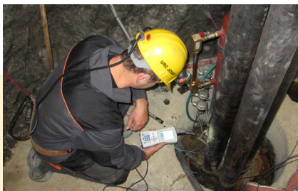
Měření termofyzikálních vlastností bentonitu
