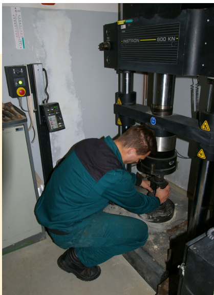
Zkouška pevnosti v tlaku
