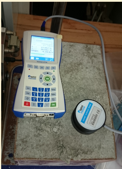
Přístroj ISOMET pro in situ měření
