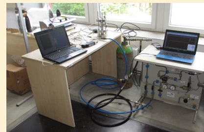
Tlakové zkoušky nenasyčeného bentonitu
