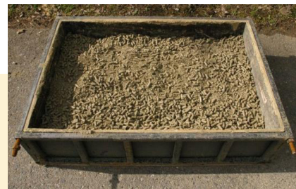
Forma pro hutnění bentonitových pelet
