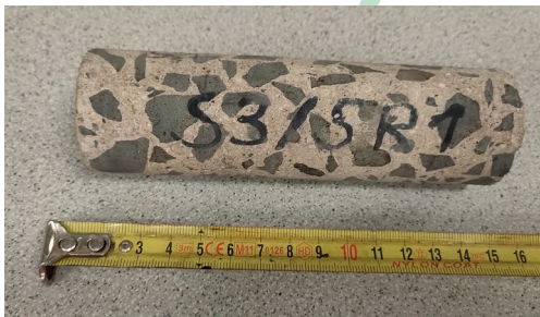
Odvrt ze vzorku betonu z ÚRAO Richard (CORI)
