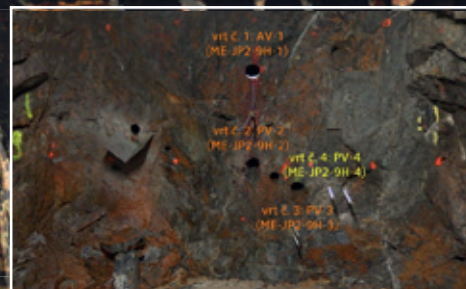
Schéma vrtů pro testy stopovačů ve štole Josef
