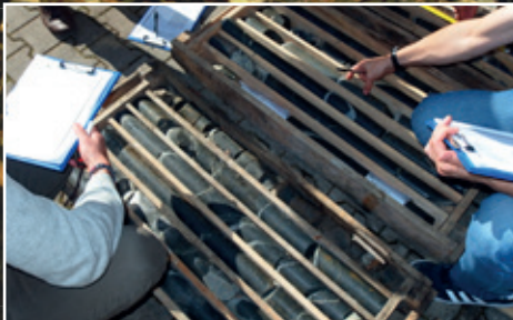
Klasifikace hornin indexem RQD
