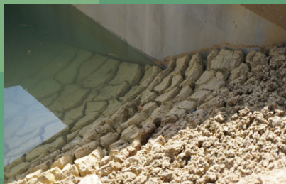
Působení tropických teplot na bentonit
