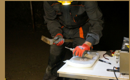
Odvrtaný vzorek bentonitu
