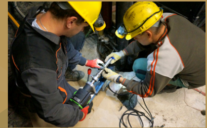
Sestava pro odebrání vzorků z bariéry
