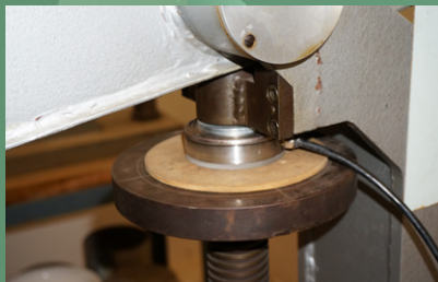
Testování buňky v reologickém lisu
