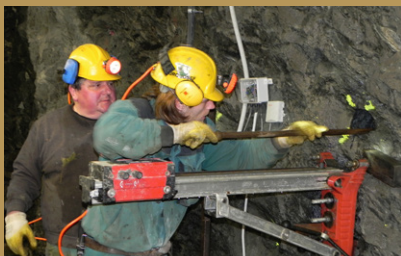
Vrty pro uložení experimentů v PVP Bukov
