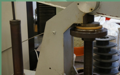
Zkouška těsnosti hydraulické buňky
