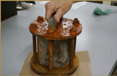
Fyzikální model pro výzkum chování bentonitu
