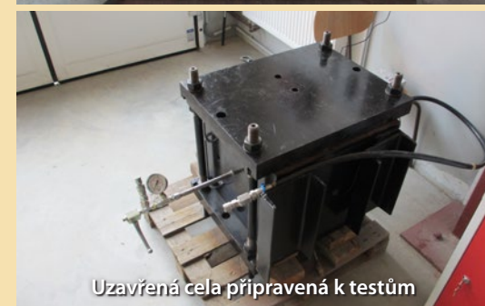
Cela s bentonitovou náplní
