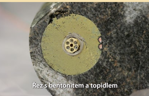
Řez odvrtaným jádrem modelu s bentonitem
