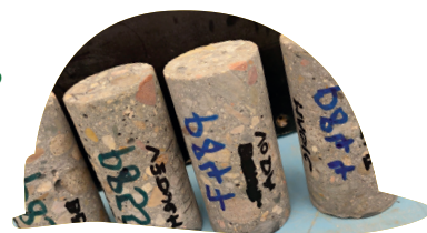
Vzorky betonu LPC_SURAO pro měření hydraulické vodivosti (MAGIC)
