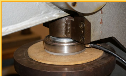
Test tlakové buňky v normálních podmínkách
