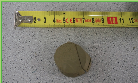
Odvrtaný vzorek bentonitu pro laboratorní analýzu
