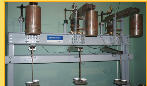
Oedometry v tepelné komoře
