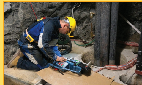
Odběry vzorků z bentonitové bariéry u modelu Mock-Up Josef
