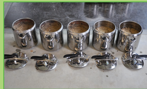
Teplně zatěžovaný bentonit v testovacích hrncích
