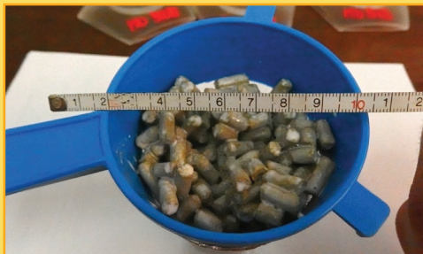
Jeden ze zkušebních vzorků kompozitu peleta-pojivo
