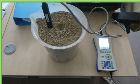
Stanovení termo-fyzikálních vlastností bentonitu
