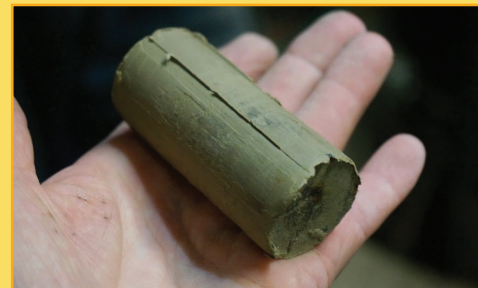
Odvrtaný vzorek pro laboratorní testy
