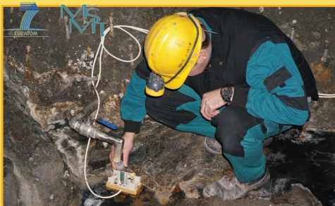
Odběr vody na výtoku z experimentální zátky
