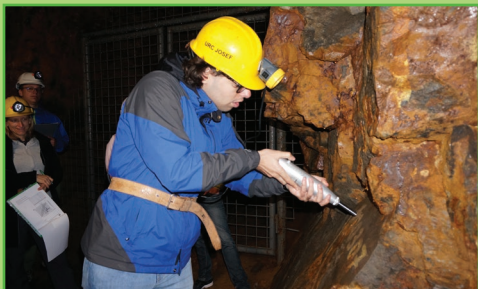
Určování tvrdosti horniny Schmidtovým kladivkem
