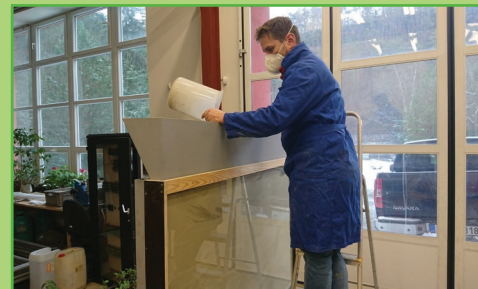
Zaplnění modelu spáry bentonitem
