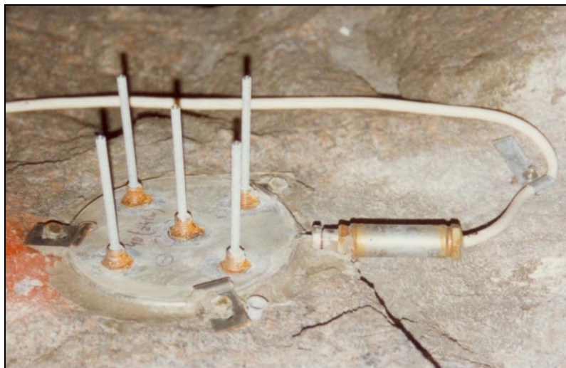
Obr. 4.11 Hydraulická tlaková buňka s ostny
