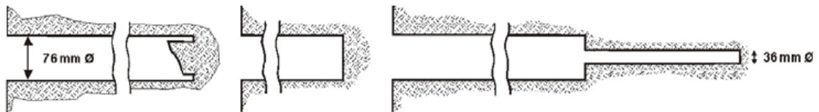
Obr. 9. 8 Metoda Hasta - 1. fáze
