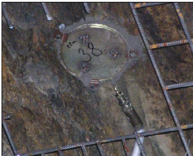
Obr. 4.6 Hydraulická tlaková buňka
