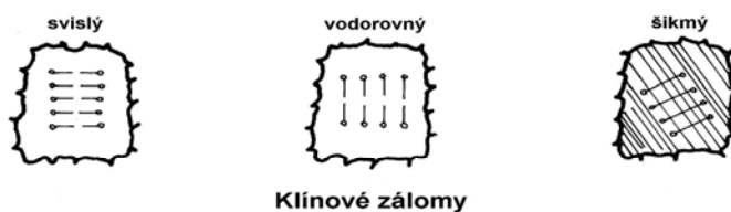
Obr. 5.1 Druhy vrtů a schéma působení výbuchu
