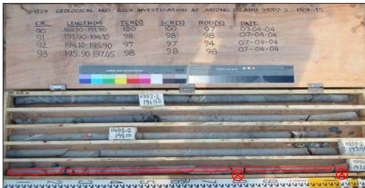
Obr. 7. 2 Ukázka vyhodnocení indexu RQD na vrtném jádře
